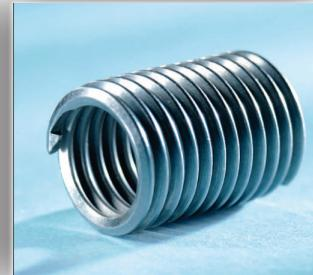
Helcoil yaylar 4 çeşite ayrıılır ve hepsi aynı yerde kullanılabilir, aynı işi görür. Ancak montaj aparatları ve takıcıları değişir. Bu yaylar üretilirken aynı paslanmaz çelik hatve yaylar kullanılır. Helcoiller kaplamaları ile farklı bir gruba ayrılırlar. Helcoil yaylarda özel uygulama ihtiyaçlarına uyacak şekilde geniş bir malzeme seçenekleri mevcuttur. Uygulamanızda doğru malzeme belirlemek için aşağıdaki bilgilere başvurunuz.
